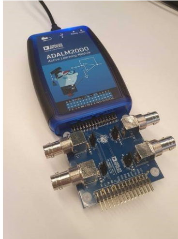
Fig. 2. Photographie d'un Adalm 2000 avec un adaptateur BNC.
